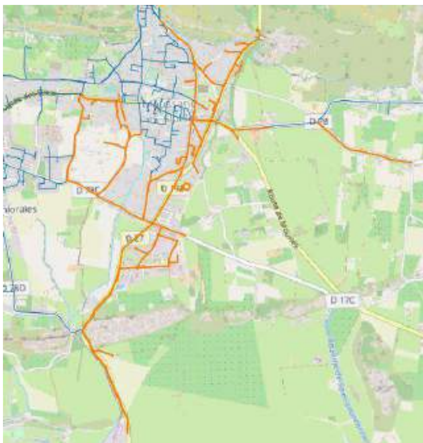
Réseau AEP de Maussane contrôlé, en orange
